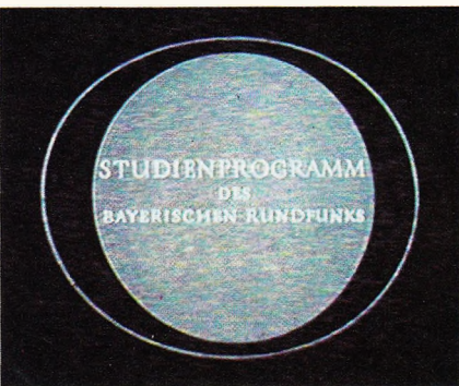
Bild F 25a. Mit Farbstörungen überlagerte Schrifttafel einer Schwarzweiß-Fernsehung bei nichtgesperrem Farbverstärker
