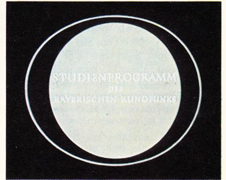
Bild F 26. Schrifttafel nach Bild F 25a bei abgeschaltetem Farbverstärker als störungsfreies Schwarzweißbild
